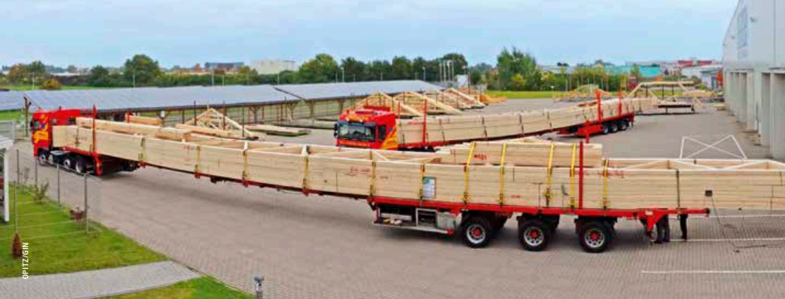
◀ Der Transport von Nagelplattenbindern erfolgt ab dem Werk mit Spezialtransportern
